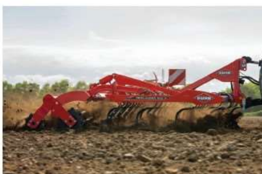
Prolander 500 R avec option réglage hydraulique de la profondeur
